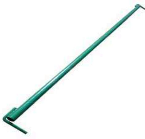
Связь диагональная нижняя ЛСШ 60 - диагональный элемент, обеспечивающий жесткость каркаса штыревых лесов в плане. Ставятся по диагонали в горизонтальной плоскости и соединяются со стойкой при помощи наваренного штыря, вставляемого в патрубок на стойке. Длина диагонального элемента зависит от размеров ячейки.
