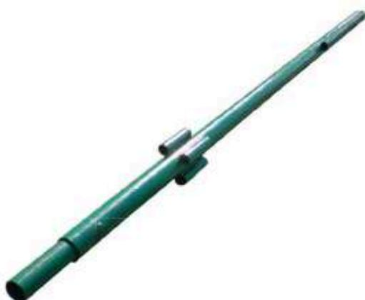
Связь диагональная верхняя ЛСШ 60 – диагональный элемент, обеспечивающий жесткость каркаса штыревых лесов в плане. Ставятся по диагонали в горизонтальной плоскости и соединяются со стойкой при помощи наваренного штыря, вставляемого в патрубок на стойке. Длина диагонального элемента зависит от размеров ячейки.
